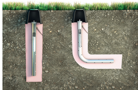
Рис. 2. Элементы конструкции электролитического заземления
