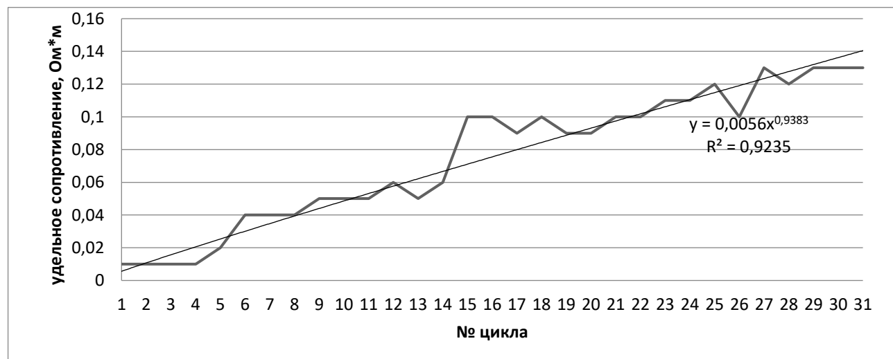
График изменения сопротивления заземлителя из оцинкованной стали
